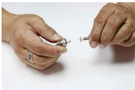
Encaixe o conector BNC.
