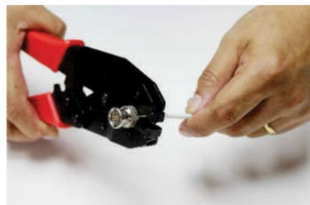
Crimp com o auxílio do alicate hexagonal.
